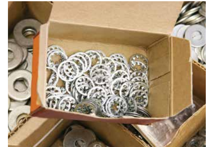
Suyla çözünebilen korozyon önleyici ile korunmuş paketlenmeye hazır parçalar
